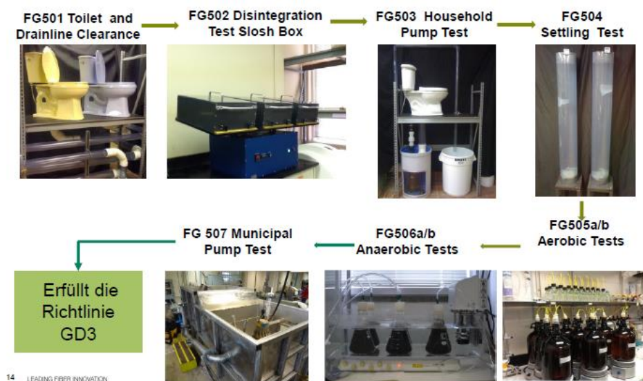
Abbildung 10: Test for „Flushability“ von der Interessenvertretung EDANA/INDA
