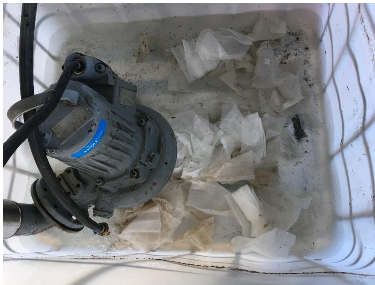
Abbildung 3: Versuchsanlage zur Pumpenverstopfung durch FT
